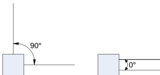
Abbildung 4.2: 0^\circ -Winkel zwischen zwei parallel verlaufenden Kantensegmenten
