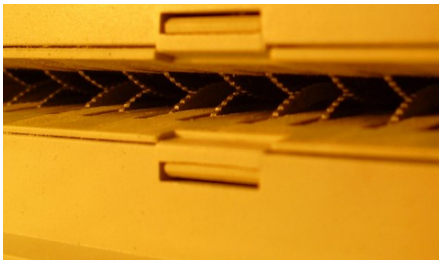
Abbildung 1.1: Die Schneidvorrichtung eines Streifenschnitt-Schredders
