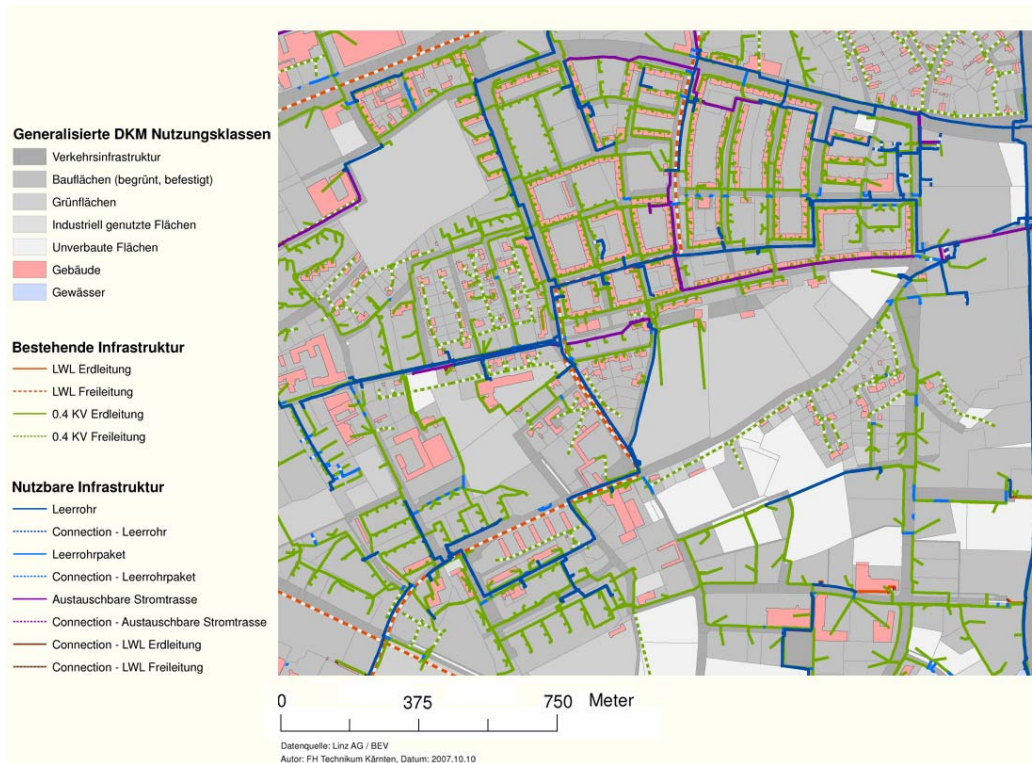
Abbildung 1. Ausschnitt der digitalen Katastralmappe (DKM) mit planungsrelevanten Landnutzungsklassen. Straßenkreuzungen und Übergänge (z.B. Brücken), die nicht in den Originaldaten enthalten sind, wurden automatisiert neu generiert.
